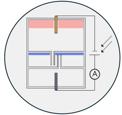
今回僕たちは以上の手順で水を電気分解することを目指します。そして、缶サットの着地姿勢を制御することで複雑な装置なしでも発生した酸素、水素を分離した状態で捕集できる缶サットを開発しました。これらの実験装置が健全に動作し、発生した酸素、水素を分離した状態で捕集できていること、または缶サットの姿勢を制御できなかったものの酸素と水素が混ざる前に電気分解が停止したことを確認することが目標です。
